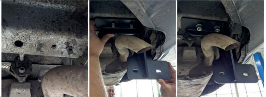
**ШАГ 2.** Зафиксируйте положение правого кронштейна на штатных шпильках возле правой подушки крепления глушителя при помощи гаек М12, шайб 12 и шайб 12 гроверных.
