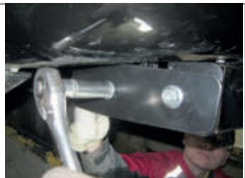
**ШАГ 6.** Установите съемный шар в сборе и закрепите его пальцем гнутым со шплинтом. Зафиксируйте съемный шар болтом M10x20 снизу. Затяните съемный шар с помощью ключа на 38 мм.
