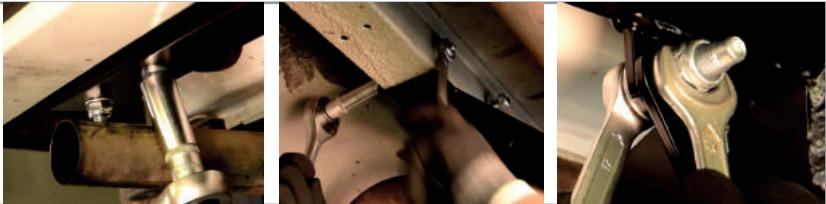
**ШАГ 5.** Установите кронштейн крепления электрической розетки. Установите съемный шар в сборе и закрепите его пальцем гнутым с шплинтом. Зафиксируйте съемный шар винтом M10x20 снизу, **ОН ИСПОЛЬЗУЕТСЯ ДЛЯ ИСКЛЮЧЕНИЯ ТЕХНОЛОГИЧЕСКИХ ЛЮФТОВ СЪЕМНОГО ШАРА И ТОЛЬКО В НЕНАГРУЖЕННОМ СОСТОЯНИИ!** Перед сцепкой болт демонтировать!
