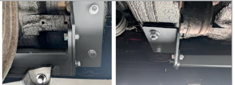
ШАГ 5. Зафиксируйте положение крюка и подразетника, соединив их отверстия с отверстиями на «ушах» балки и закрепив их болтами М12х1,25х80, шайбами 12, шайбами 12 гроверными и гайками М12х1,25.
