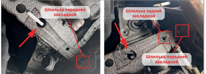
ШАГ 3. Будучи с левой стороны автомобиля, наживите на шпильку задней закладной металлическую прокладку, после чего зафиксируйте положение левого кронштейна, наживив его на шпильки закладных с помощью шайб 12, шайб 12 гроверных и гаек М12х1,25. Прделайте те же самые действия с правой стороны автомобиля.
