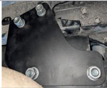
**ШАГ 3.** Наживите балку ТСУ на левый и правый основные кронштейны. Зафиксируйте положение балки, используя для крепления болты M12x1,25x40, шайбы 12 и гроверные, шайбы 12 и гайки M12x1,25.
