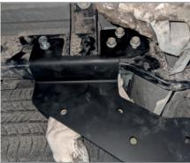
ШАГ 2. Установите в правый лонжерон закладную деталь таким образом, чтобы шпильки закладной детали прошли через соотоветствующие отверстия, указанные на фото справа. Установите усилитель кронштейна, используя болты М12х1,25х40, гайки М12х1,25, шайбы 12 и шайбы 12 гроверные. Повторите ту же операцию с левой стороны автомобиля. Соединения не затягивать!
