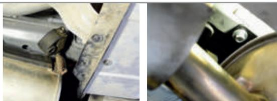
**ШАГ 4.** Для установки балки ТСУ, вставьте в буксирную петлю две шайбы 28x13 из комплекта поставки (исп. только для Н6). Затем, совместив отверстие в центре балки с отверстиями в шайбах, закрепите всё с помощью болта M12x1,25x60 с гайкой M12x1,25 через две шайбы 12 с двух сторон и гровер 12. Затем соедините боковые кронштейны с балкой ТСУ болтами M10x1,25x40 через шайбы 10 и гайки M10.
