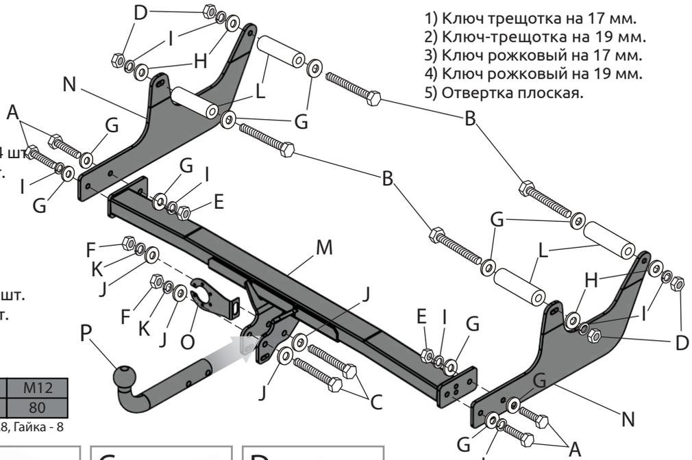
Table with 3 columns: Диаметр резьбы (M10, M12), Момент затяжки, Нм (47, 80)
