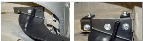
**ШАГ 4.** Установка правого кронштейна производится аналогично установке левого кронштейна, соединения не затягивайте.
