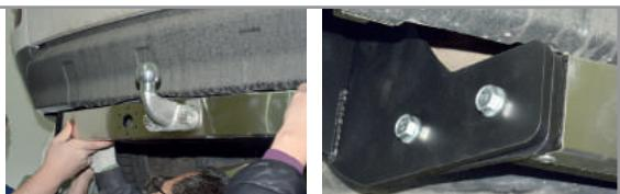
**ШАГ 6.** Отрегулируйте положение фаркопа, обеспечив небольшой зазор между центральным кронштейном и бампером автомобиля.
