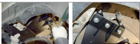
**ШАГ 5.** Установите балку ТСУ между боковых, совместив отверстия балки ТСУ и боковых кронштейнов, и соединив всё с помощью болтов M12x1,25x40 через шайбы 12 с двух сторон и шайбы 12 гроверные, гайками M12x1,25
